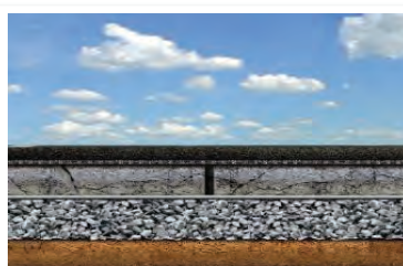
Sanierung von Betonflächen mit Asphalt
